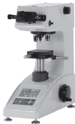
Рис. 7.1. Внешний вид микротвердомера MVD402 Wolpert Wilson Instruments
